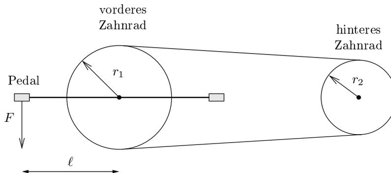
Das vordere Zahnrad hat Radius  $r_1$ , das hintere hat Radius  $r_2$  und die Kurbel hat Länge  $l$ .
