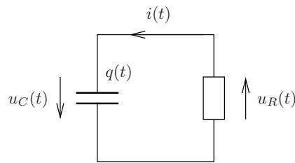
Die Ladung des Kondensators zur Zeit  $t$  sei  $q(t)$  Coulomb. Die Stromstärke  $i(t)$  ist die zeitliche Ladungsänderung, d.h.
