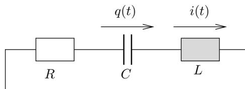
Der Zustand dieses Systems ist durch die Stromstärke und die Ladung des Kondensators gegeben, d.h. durch den Vektor
